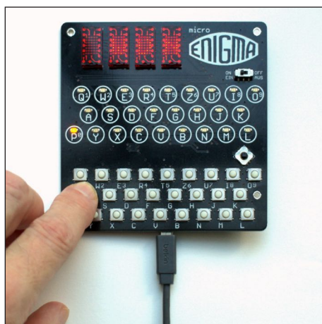
La micro Enigma en fonctionnement. Quand on appuie sur la touche A, la lampe de la lettre chiffrée (ici P) s'allume
