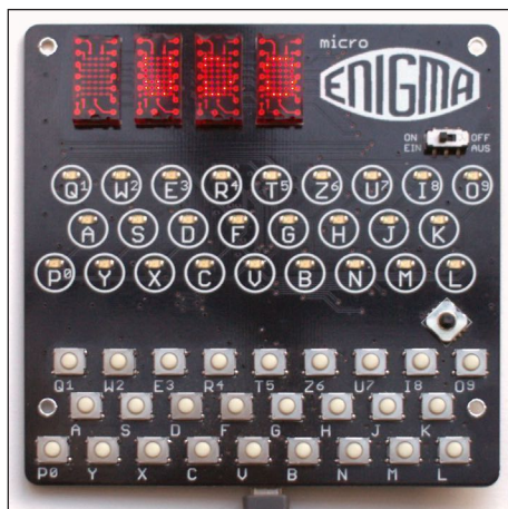
La micro Enigma configurée en machine à trois rotors. Ils sont ici sur les positions WDO
