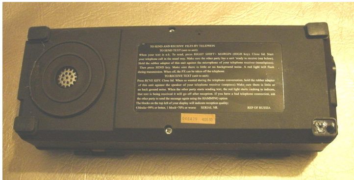
Le PX1000cr vu de dessous. Le coupleur acoustique est visible à gauche. A noter la mention en bas et à droite des consignes de transmissions : « Rep of Russia » !
