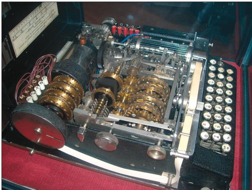
Figure 13: L'intérieur de la B-211 équipé du surchiffreur
