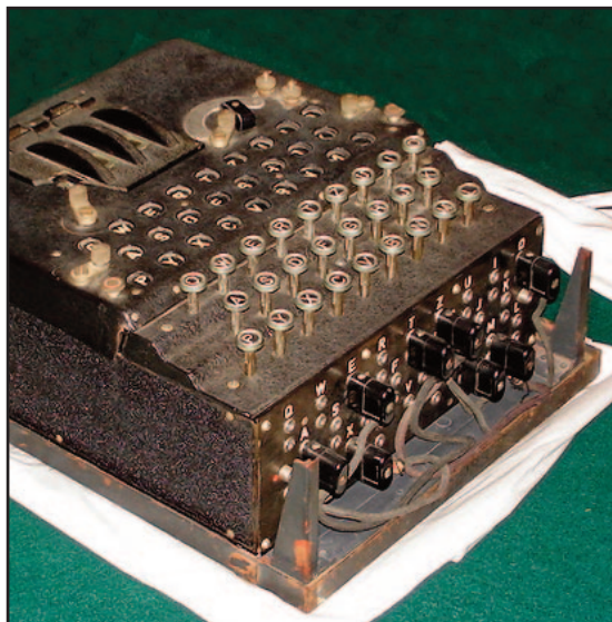
Avant d'une Enigma montrant le tableau de fiches( stecker )
