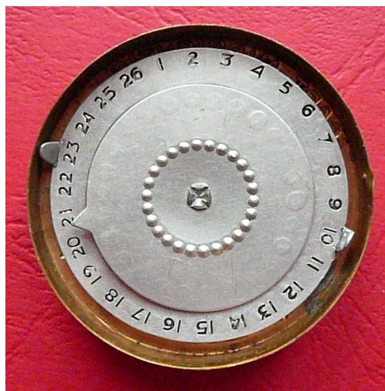
ci-dessus le code-o-graph de 1948. La lettre en clair gravée sur le grand disque intérieure, apparaît dans la fenêtre de droite. La molette centrale fait tourner le petit disque intérieur et la lettre codée apparaît dans la fenêtre de gauche.
