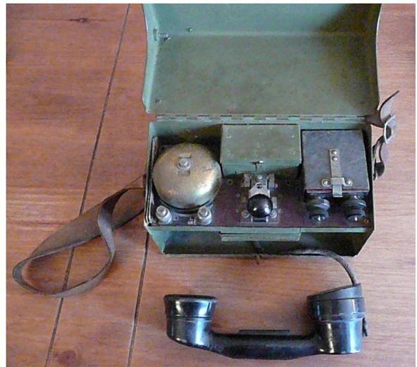
*Il suffit de deux fils pour communiquer en morse. Ce téléphone de campagne d'origine canadienne est muni d'un buzzer sur sa partie supérieure. Si la communication vocale est de mauvaise qualité, les opérateurs peuvent aussitôt transmettre en morse, et écouter la réponse par le biais des écouteurs.*
