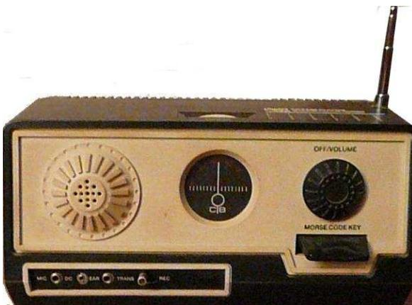
*Certains radio-amateurs, fidèles aux traditions, continuent à communiquer en morse. Ci-dessus un petit émetteur-récepteur disposant d'une prise micro, mais la languette au milieu à droite est un buzzer pour les communications en morse.*
