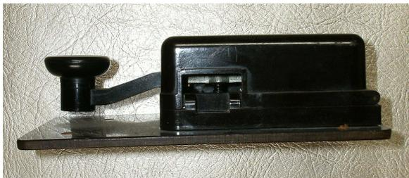
*Pour transmettre des impulsions plus ou moins longues, l'opérateur de morse se sert d'un buzzer, qui n'est qu'un contacteur électrique.*
