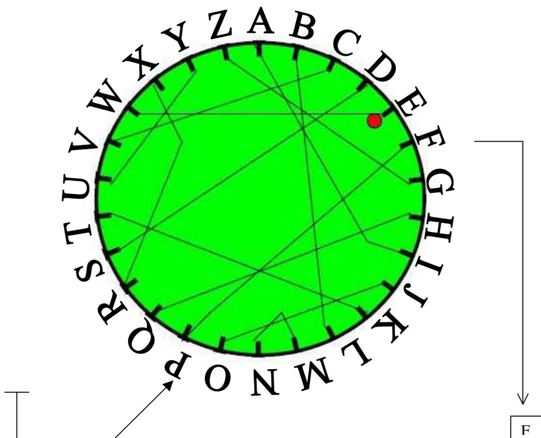
Il suffit de taper ensuite la lettre A, le courant traverse le rotor, et c'est l'ampoule H qui s'allume.
